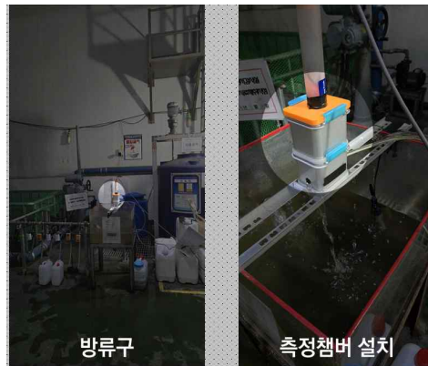
[그림 28] 현장 실험용 탁도센서 및 현장 설치 모습
