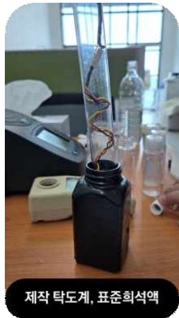
[그림 27] 제작된 탁도계 및 탁도에 따른 검출 값의 상관성 분석 결과
