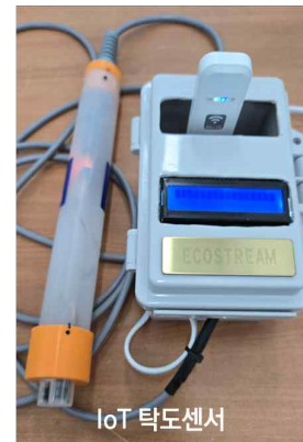
[그림 27] 제작된 탁도계 및 탁도에 따른 검출 값의 상관성 분석 결과
